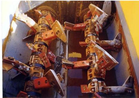
写真 3-5 2軸強制練りミキサー（内部）
