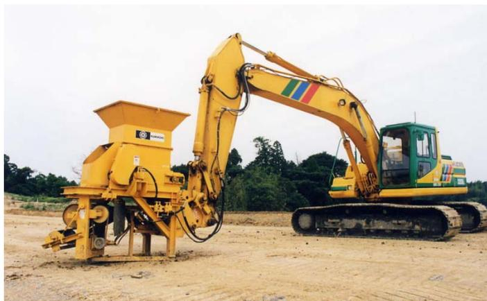
写真 3-7 高速ベルトコンベア式撒きだし機
