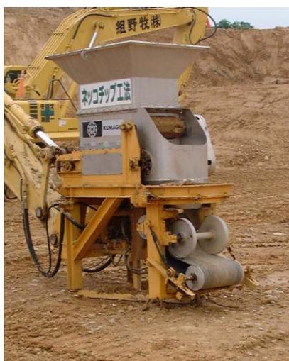
写真 3-8 高速ベルトコンベア式撒きだし機
